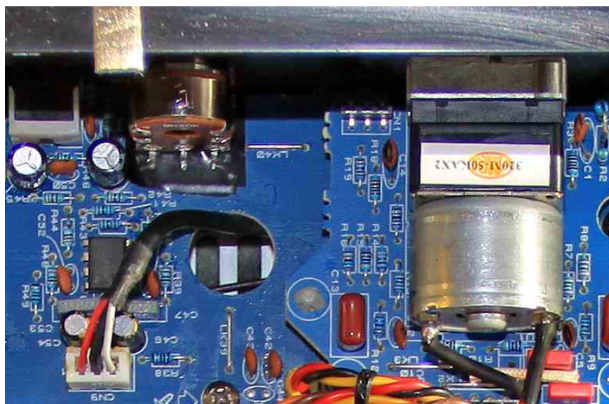
Rysunek 6: Widok zdemontowanego potencjometru balansu
