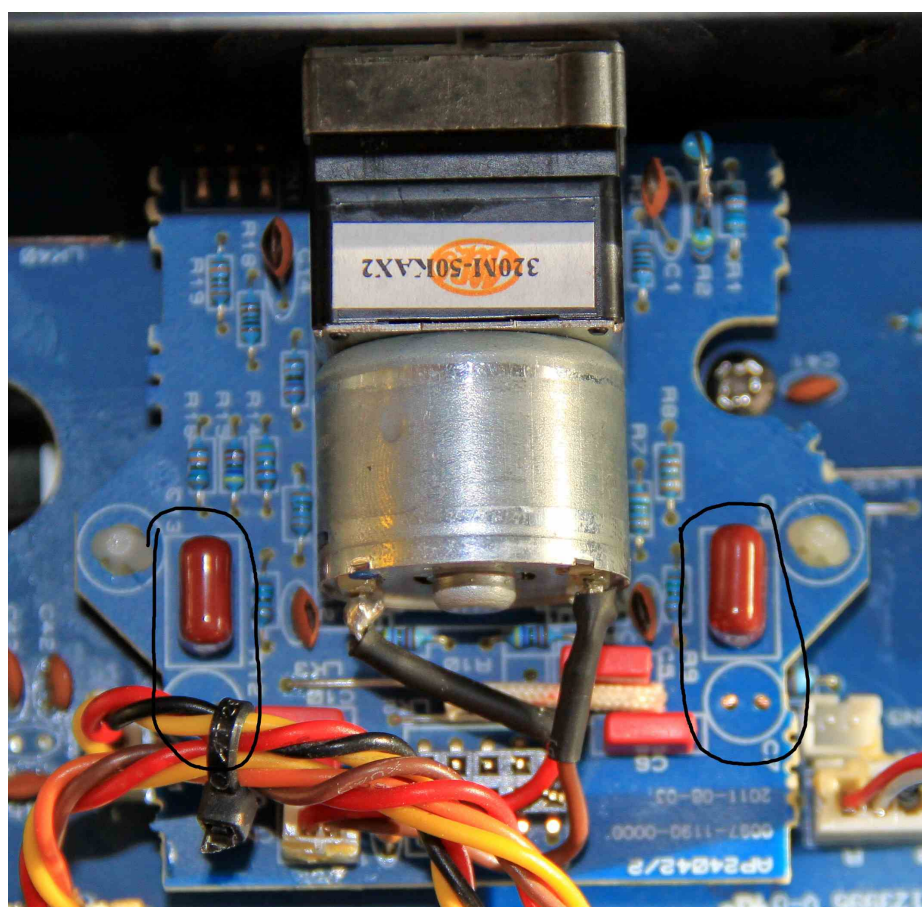
Rysunek 3: Kondensatory przy potencjometrze głośności
