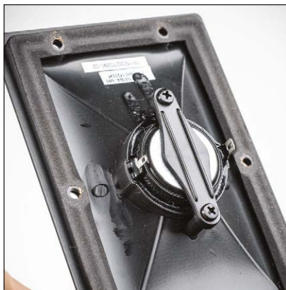
Tekstylna kopułka ma typowy dla tanich głośników magnes neodymowy. Falowód wykonano z ABS-u.
