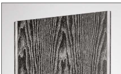
Górna ścianka nie jest równoległa do spodu. Opada pod kątem 6 stopni. Dobra jakość okleiny.
